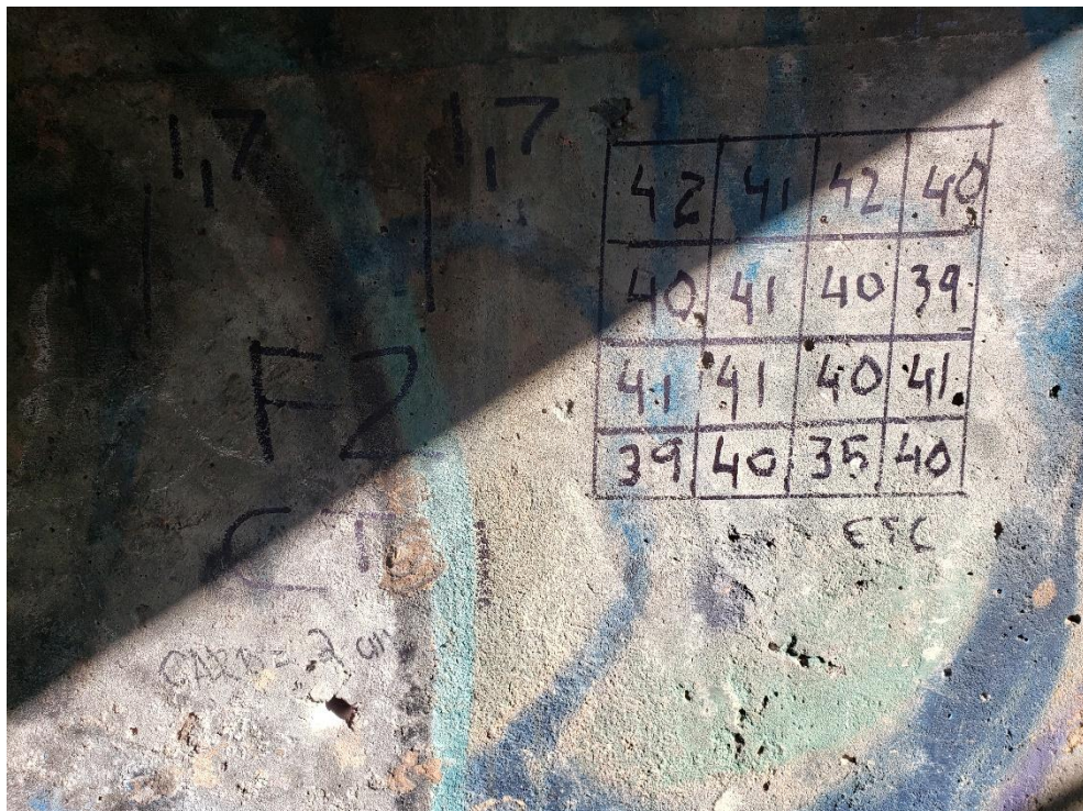
Figura 51 - Ensaio de Esclerometria - Resultado médio = 40,1Mpa
