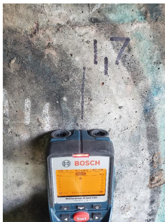
Figura 49 - Ensaio de pacometria - Identificação do posicionamento da armadura existente
