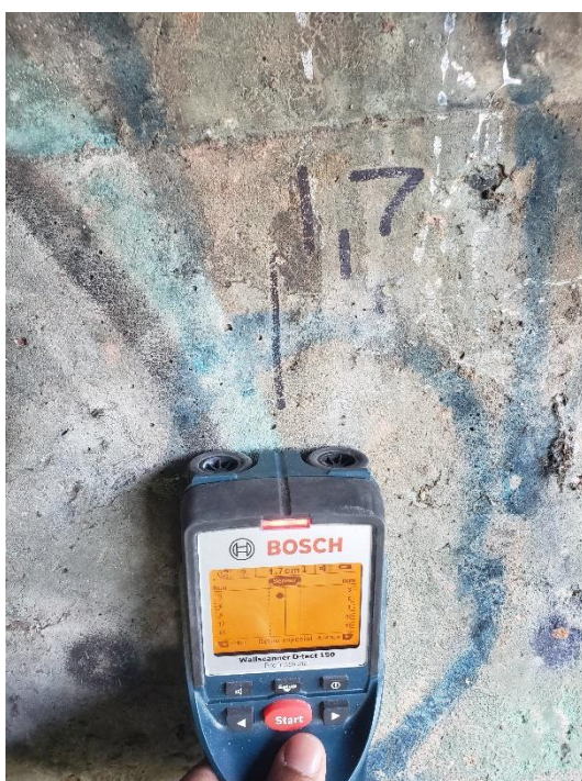
Figura 49 - Ensaio de pacometria - Identificação do posicionamento da armadura existente
