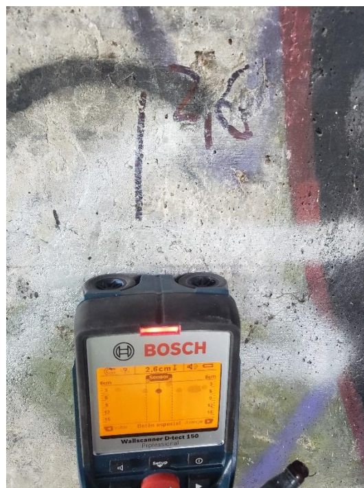
Figura 43 - Ensaio de pacometria - identificação do posicionamento da armadura existente
