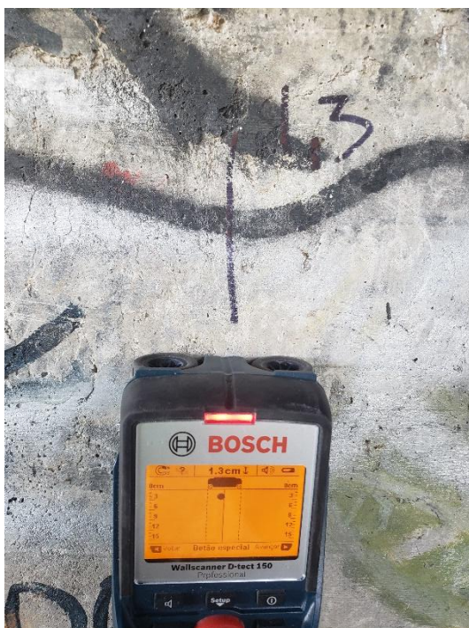
Figura 43 - Ensaio de pacometria - identificação do posicionamento da armadura existente
